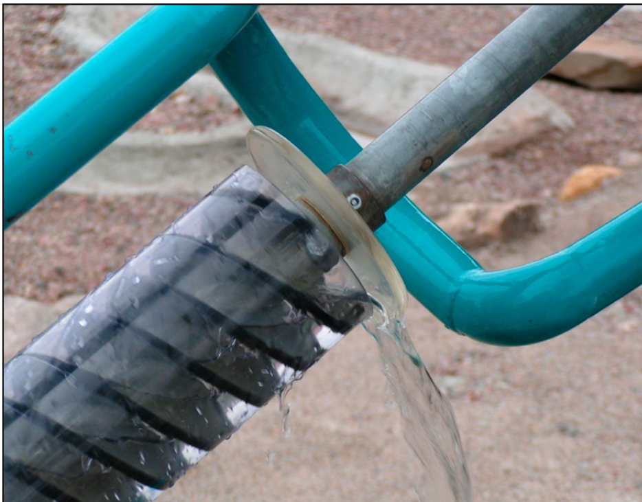
Archimedes skruv flyttar vatten från en låg nivå till en högre.
